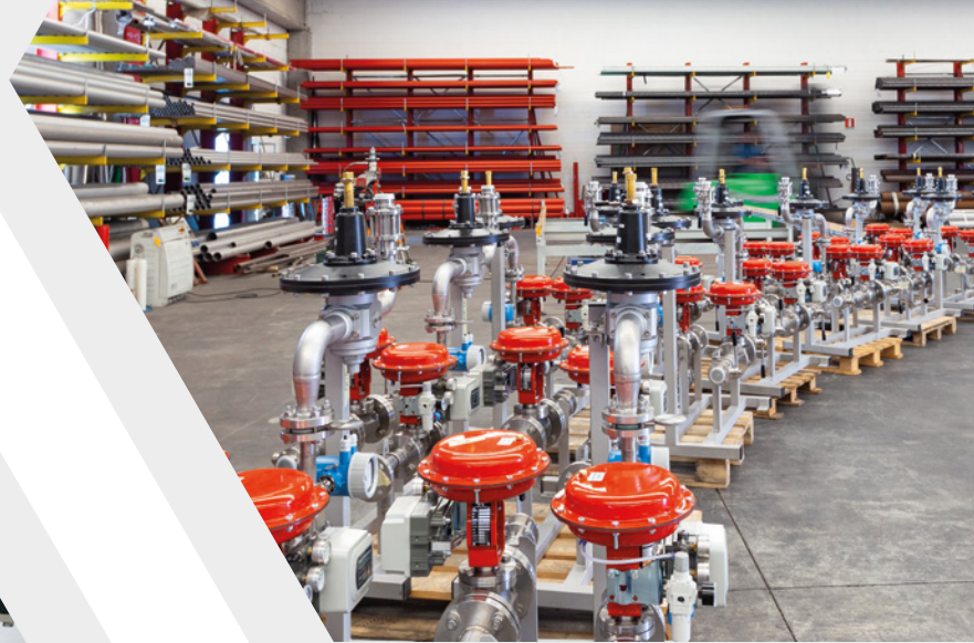
1. Skid intertizzazione serbatoi per impianto automatico di verniciatura
